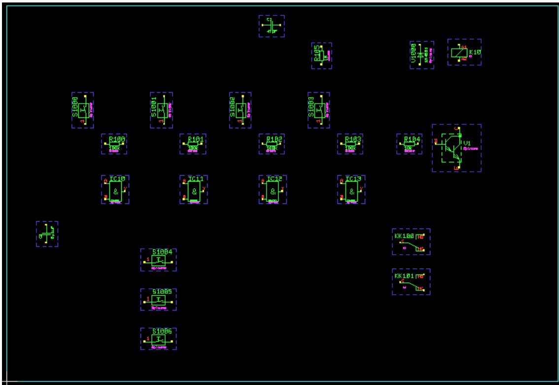
Abbildung 2-4: Stromlauf mit platzierten Symbolen
